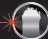
La poudre de carbure dur est appliquée au laser à haute puissance sur la tranche de la lame
